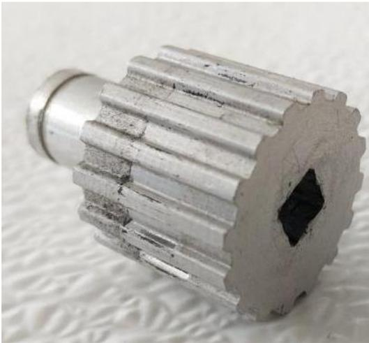
*Abbildung 8-42: Ursprüngliche Zahnriemenscheibe mit linksseitigem Lagersitz*
