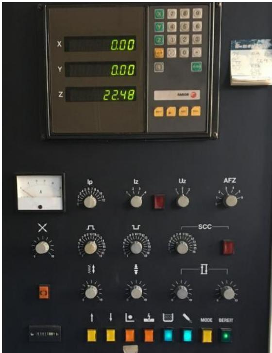
Abbildung 8-40: Eingestellte Maschinenparameter
