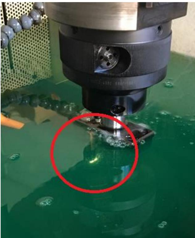
Abbildung 8-39: Erodiervorgang unter Petroleumflutung
