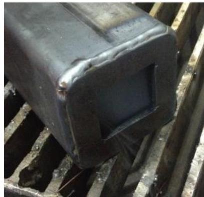
Abbildung 8-54: Verschweißen der Abschlussplatte
