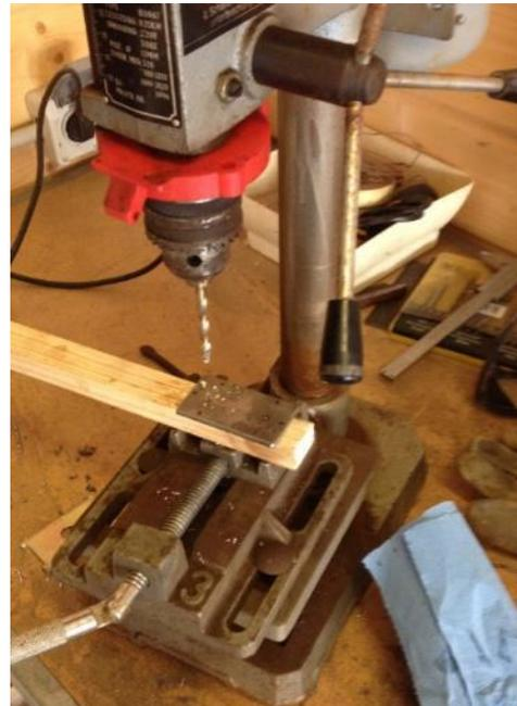
Abbildung 8-49: Bohren der Verbindungswinkel
