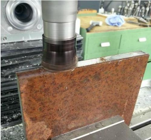
Abbildung 8-22: Planfräsen mittels Wendepplattenfräser
