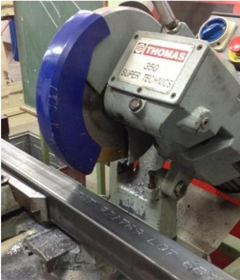
Abbildung 8-52: Zuschnitt der Formrohre
