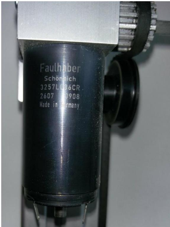
Abbildung 8-31: Gleichstrommotor (Faulhaber 3257L036CR) für den Antrieb des Zahnriemens
