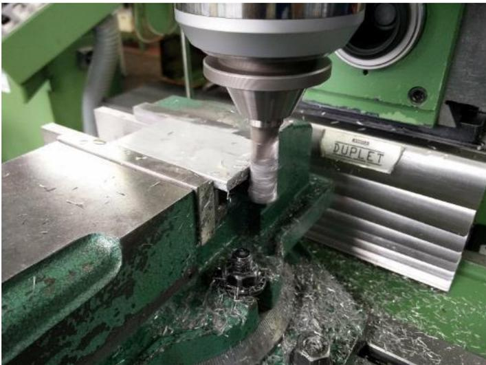
Abbildung 8-6: Stirnfräsen der Adapterplatte
