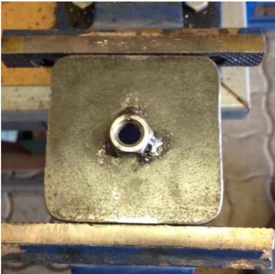
Abbildung 8-50: Bodenplatten der Fußholme
