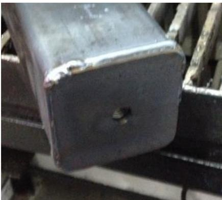
Abbildung 8-53: Verschweißen der Bodenplatte
