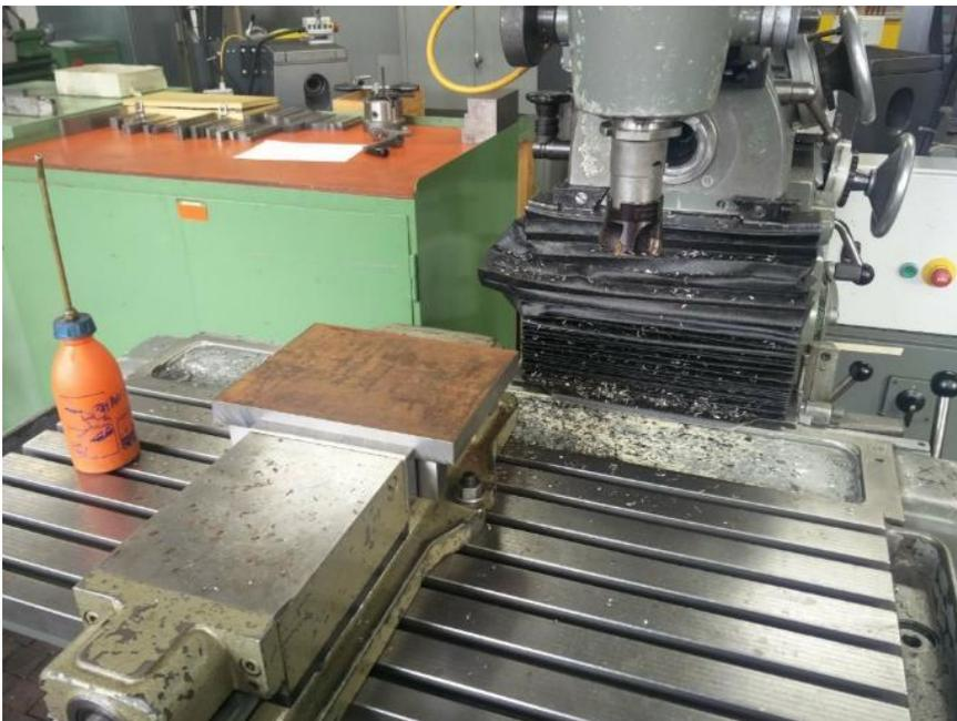
Abbildung 8-24: Planfräsen der Ober- und Unterseite mittels Wendepplattenfräser
