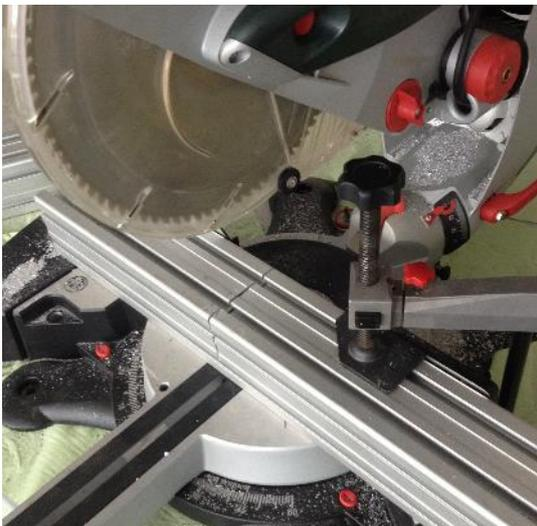
Abbildung 8-60: Zuschnitt der Aluminium Profile
