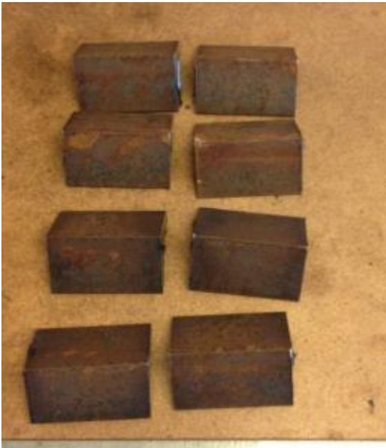
Abbildung 8-48: Zugeschnittenen Verbindungswinkel
