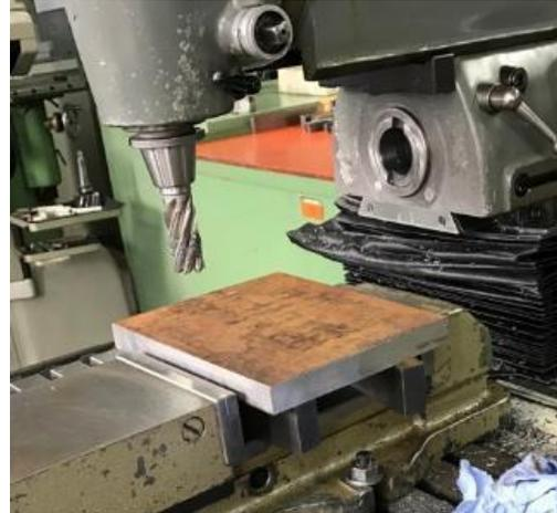
Abbildung 8-23: Planfräsen der Stirnseiten mithilfe HSS-Stirnfräser
