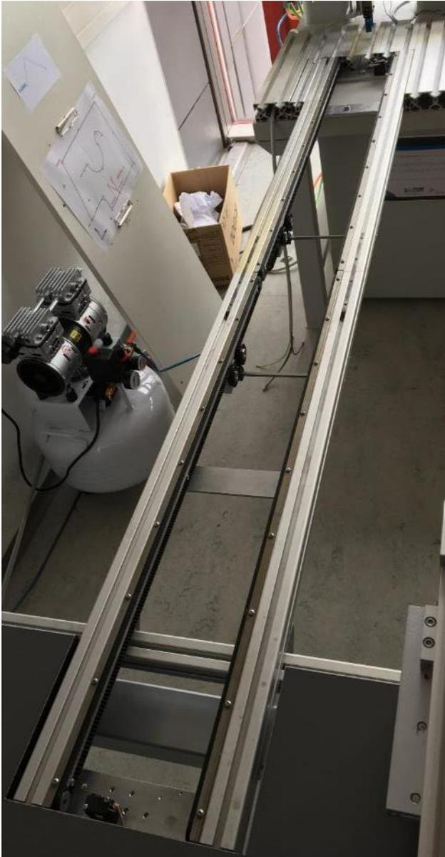
Abbildung 8-47: Montierter Bandförderer
