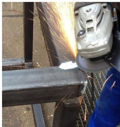
Abbildung 8-58: Verschleifen der Schweißnähte
