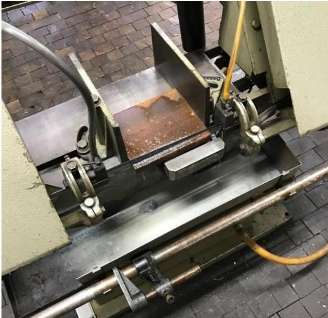
*Abbildung 8-21: Zurechtschneiden mit Hilfe einer Bandsäge*
