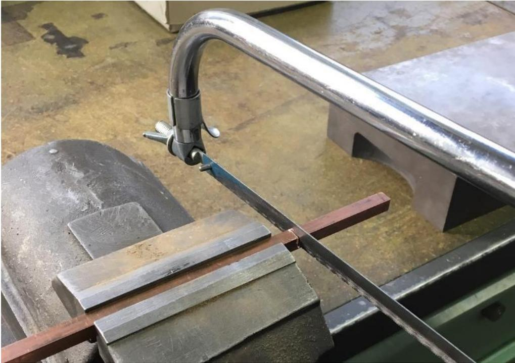
*Abbildung 8-34: Zuschneiden der Bronze-Elektrode*
