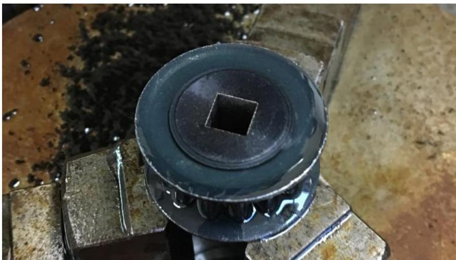
Abbildung 8-41: Erodierter Zahnriemenscheibe
