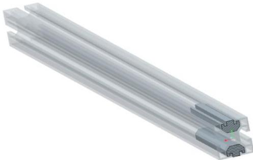
Abbildung 7-10: Zwei Längsverbinder in den Nuten des Längsprofils (Schnittdarstellung)
