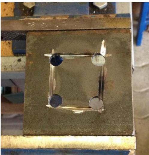
Abbildung 8-51: Abschlussplatten der Fußholme
