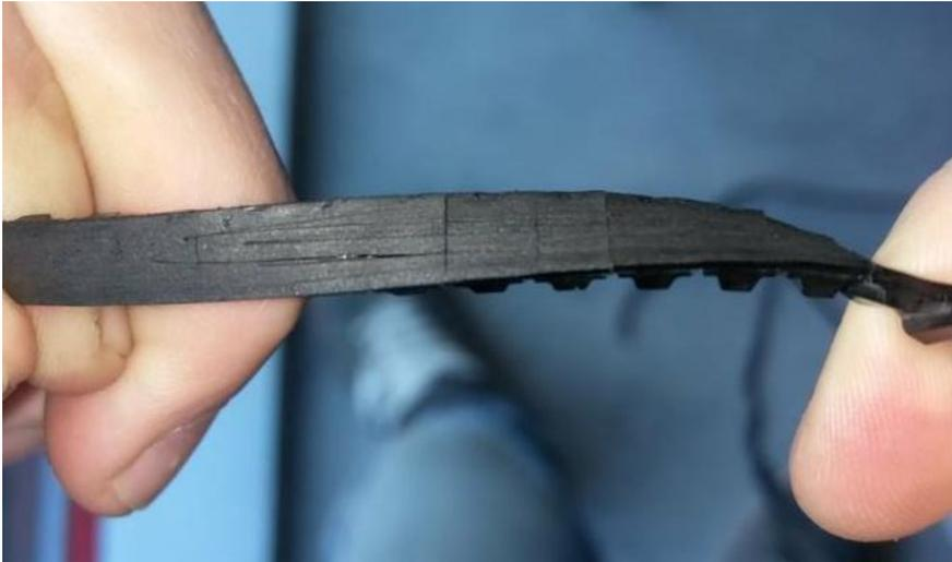
Abbildung 5-2: Zahnriemen alt, Beschädigungen
