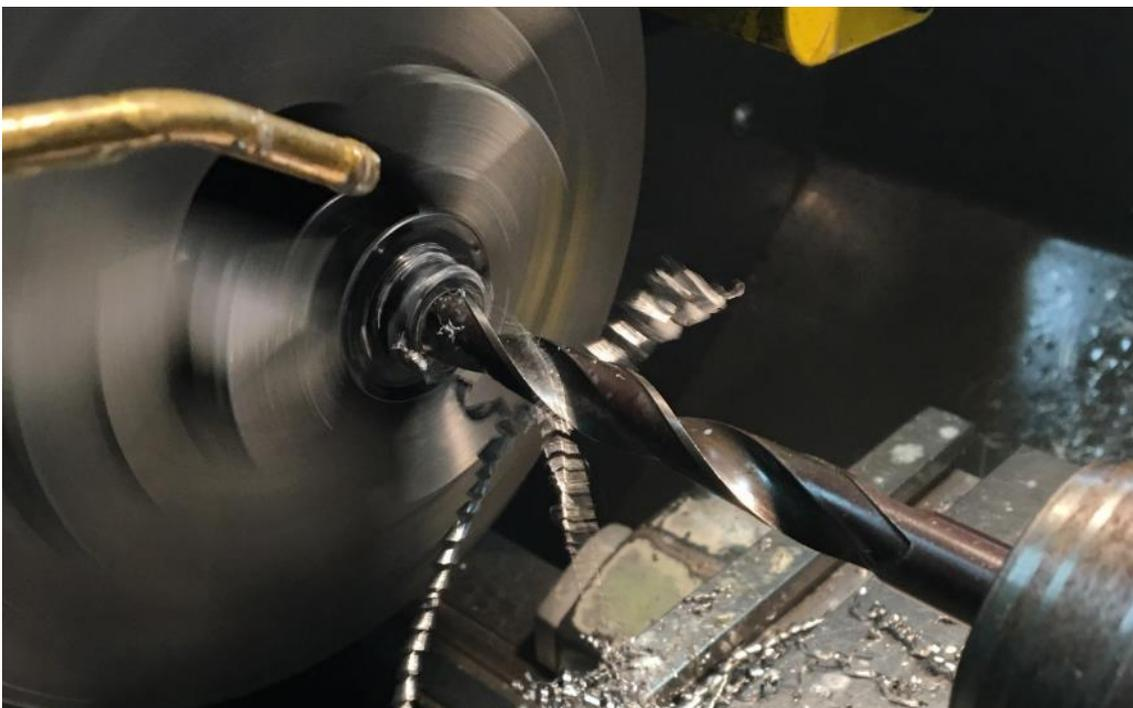
*Abbildung 8-43: Aufbohren der Zahnriemenscheibe*
