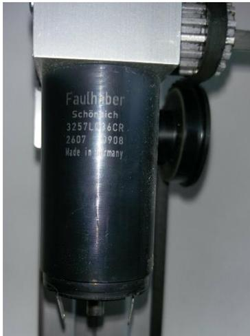
Abbildung 4-7: Vorhandener Gleichstrommotor (Faulhaber 3257L036CR)
