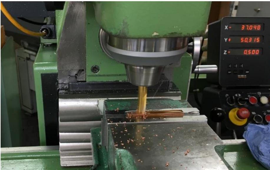
Abbildung 8-35: Fräsen der Erodier-Elektrode
