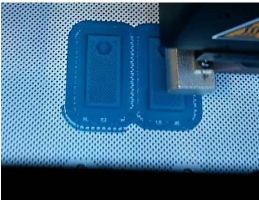
Abbildung 8-4: Füllung der Finger während des Drucks
