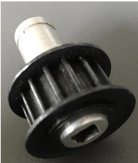
Abbildung 8-45: Aufgespresste lagerseitige Zahnriemenscheibe
