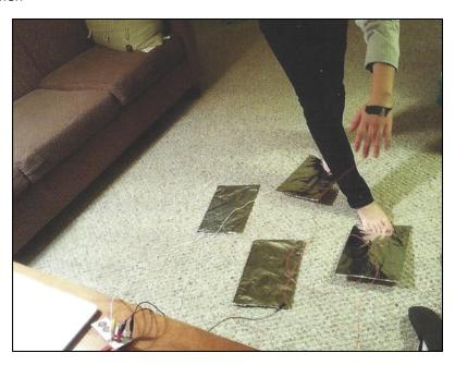
Alufolie soll um eine Seite der Kartons gewickelt werden. Mit Isolierband werden auf der Alufolie lange isolierte Drähte (Kabel) befestigt. Diese werden dann über Krokoklemmen mit dem Makey Makey verbunden (rauf, runter, links, rechts, space). Als Erdung ein Kabelstück mit Isolierband zum Beispiel auf die Handfläche kleben.
